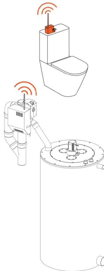
Ein Funktaster, der in jeden Spülkasten einer Toilette installiert wird, teilt der Steuerung den Zeitpunkt einer Toilettenspülung mit. Die Abwasserweiche schaltet in diesem Moment auf Schwarzwasserstellung und das fäkalbeschmutzte Abwasser fällt durch die Weiche hindurch.
